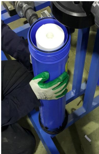
فیلتر کارتریج در داخل محفظه نگهدارنده
